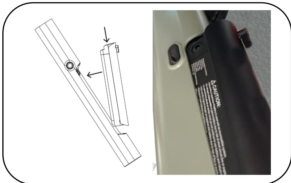
Schieben Sie den oberen Teil des Akkus in den Rahmen, bis Sie spüren, dass der Akku einrastet. Drehen Sie den Verriegelungshebel, damit der Akku nicht herausfallen kann.
